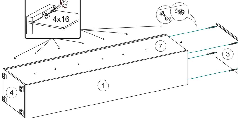
4. Используя внутренние петли и шурупы 4x16 закрепите фасад №6 к боковине №1.
