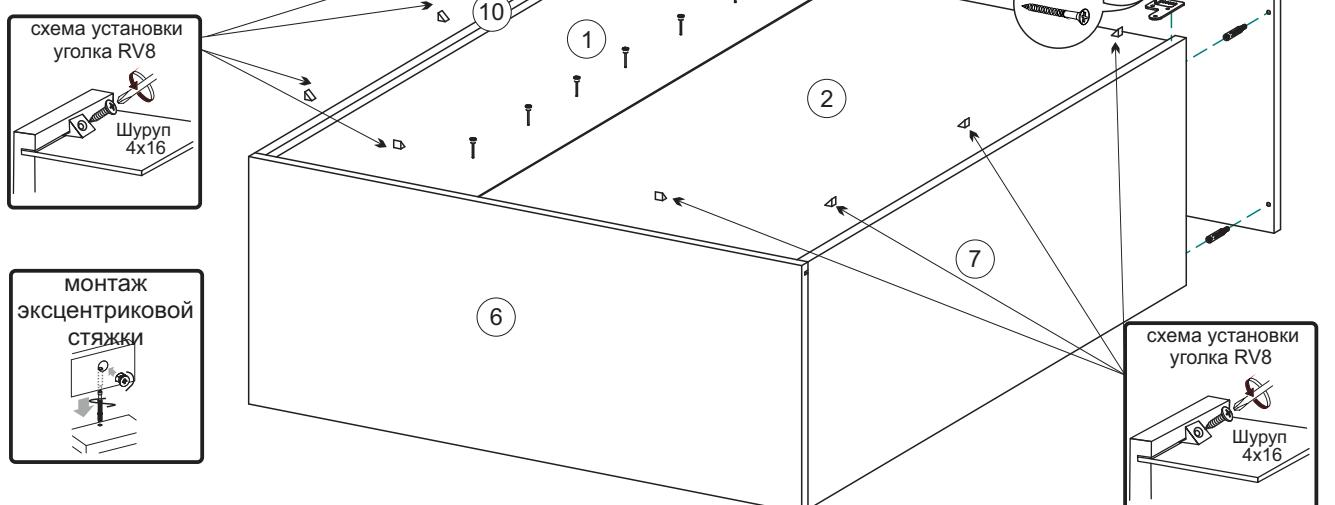
**4.** Соберите вторую часть модуля - полку. Для этого сначала приверните при помощи шурупов 4x16 к задней стенке 5 навес, затем евровинтом закрепите полки 4 к задней стенке 5 как показано на схеме 3.
