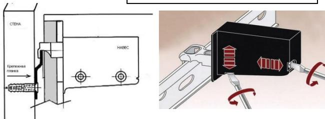
Рис. 3 Схема регулировки навесов
