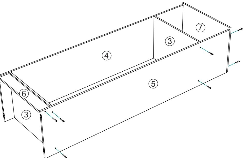
2. Чтобы установить задние стенки (деталь №1), необходимо собранную конструкцию перевернуть лицевой стороной вниз. Замерить, с помощью рулетки, и уравнять диагонали. Наложить задние стенки, соединив их бруском. Аккуратно, не нарушая диагоналей, прибить ЛДВП гвоздями, шагом 130-150 мм.
