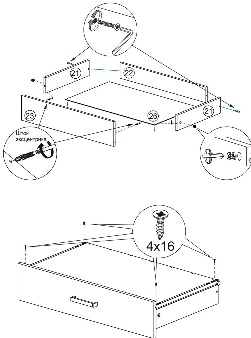
Предварительно закрепить опоры шурупами
