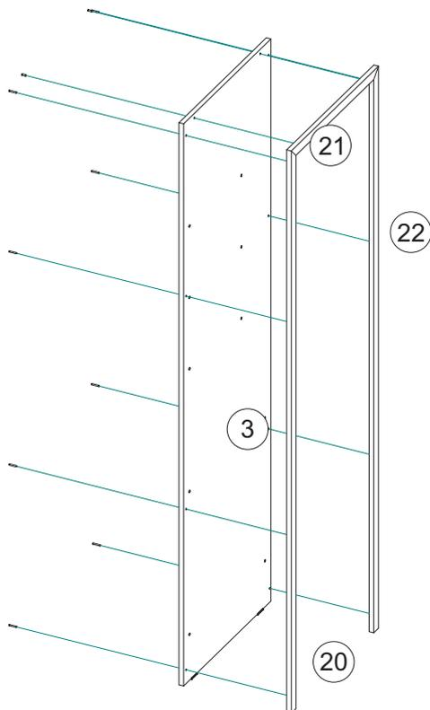
5. Используя шурупы 4x30 соедините профиля №20, №21, №22 с задней стенкой №3. Установите прямые навесы на задней стенке №3 для дальнейшего ее крепления к стене
