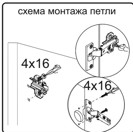
Регулирование зазоров и положения дверей с петлями
