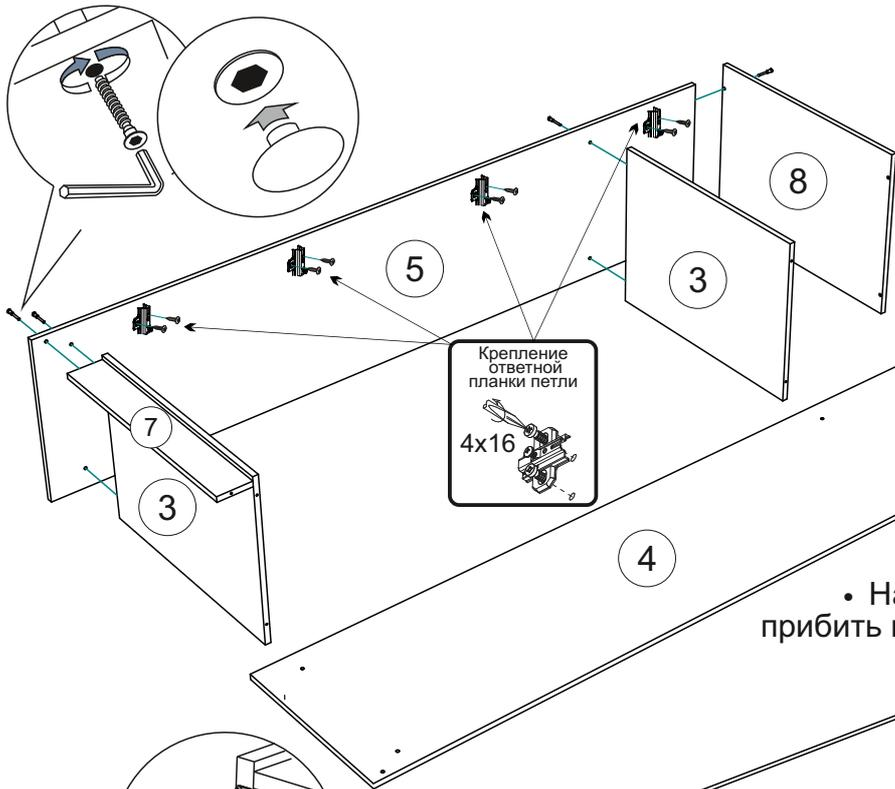
1. Сборка производится горизонтально, тыльной стороной вниз. Предварительно необходимо отобрать боковины 4, 5, ориентируясь на сверловку при помощи саморезов 4x16 привернуть к ним ответные планки петель.
