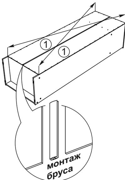
2. Чтобы установить задние стенки (деталь №1), необходимо собранную конструкцию перевернуть лицевой стороной вниз. Замерить с помощью рулетки, и уровнять диагонали.
