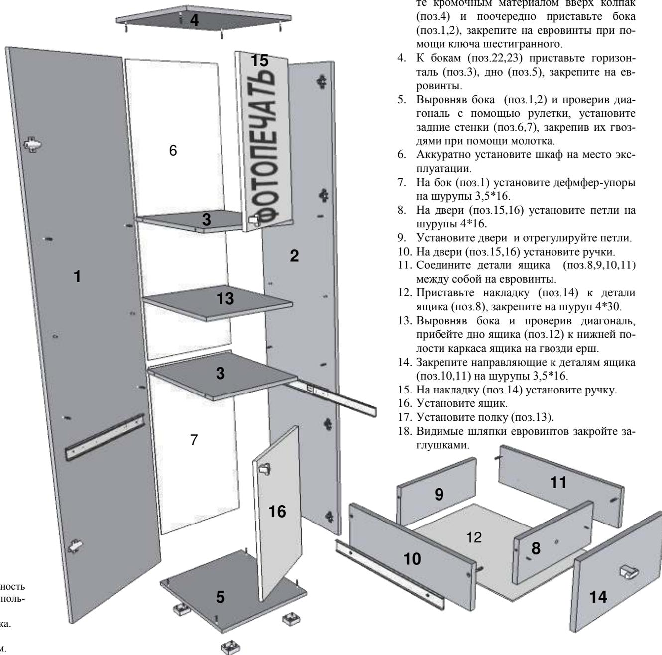
3. На чистую ровную поверхность установите кромочным материалом вверх колпак (поз.4) и поочередно приставьте бока (поз.1,2), закрепите на евровинты при помощи ключа шестигранного.
